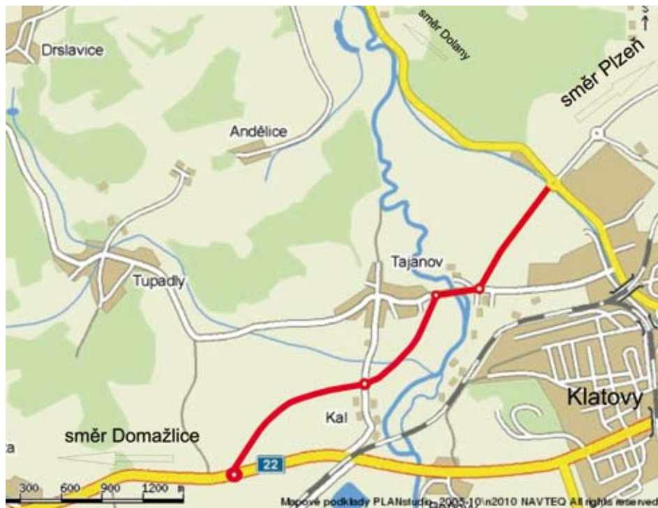
Takto vypadá druhá etapa severozápadního obchvatu Klatov, která spojí klatovskou Koldinovu ulici se silnicí I/22 nedaleko obce Kal.
