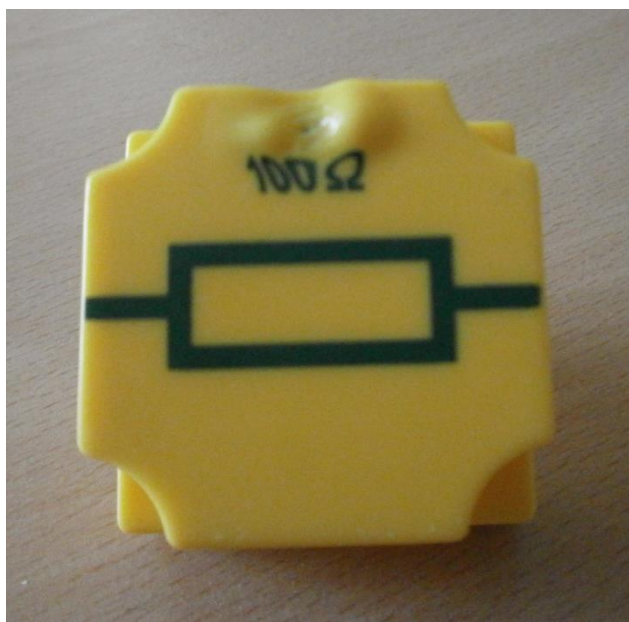
Obrázek 9: Poškozená součástka elektrické stavebnice
