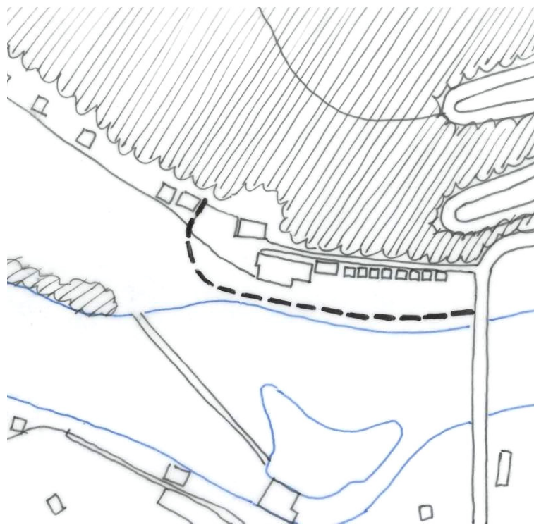
Návrh opatření pro ochranu před povodněmi Varianta B ochrana stavebních objektů zázemí, parkoviště, ubytovacích chatek a plochy pro karavany (kresba: Veronika Šindlerová)
