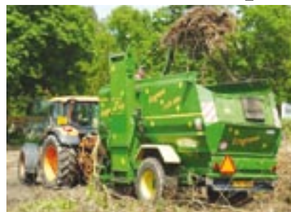
Dvě střediska SÚS Stříbro jsou vytápěna odpadovou dřevní hmotou, která vzniká při údržbě stromů kolem silnic. Drtička dokáže zpracovat nejen větve až do průměru dvaceti centimetrů, ale i veškeré ostatní dřevní hmoty, například staré palety.
